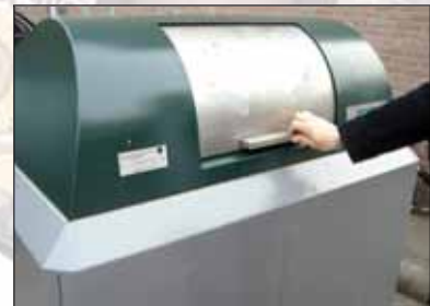
De klep sluiten. Deze wordt automatisch na enkele seconden op slot gedaan, en het systeem gaat in rust, tot de volgende gebruiker zich meldt.
