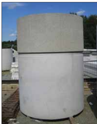
2-delige betonput. Beton-kwaliteit C30/37 XC4, grondwaterbestendig.
